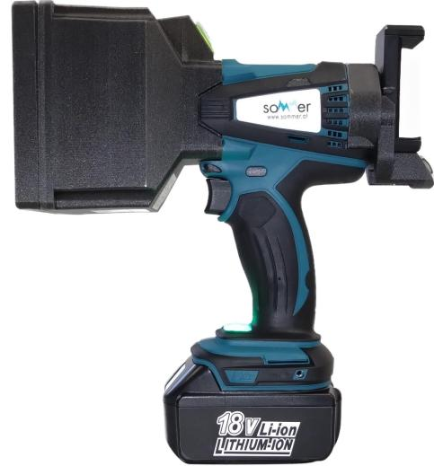
Der HSR-10 mobile Radarsensor ist ein Messgerät zur berührungslosen Bestimmung der Fließgeschwindigkeit von offenen Flüssen und Kanälen. Der Sensor erfasst die Oberflächenströmungsgeschwindigkeit nach dem Prinzip der Doppler-Frequenzverschiebung.
