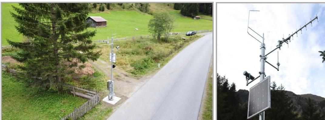
Es besteht die Möglichkeit für die Einbindung einer speziellen Time-Laps Kamera welche eine geringen Energie und Speicherbedarf hat und somit auch Autark betrieben werden kann.
