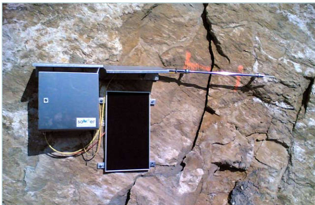
Solarversorgtes Fissurometer mit Funkstrecke zur Datenerfassung
