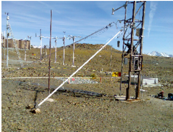
Fig. 11: Geneigter SPA Sensor am Weissfluhjoch
