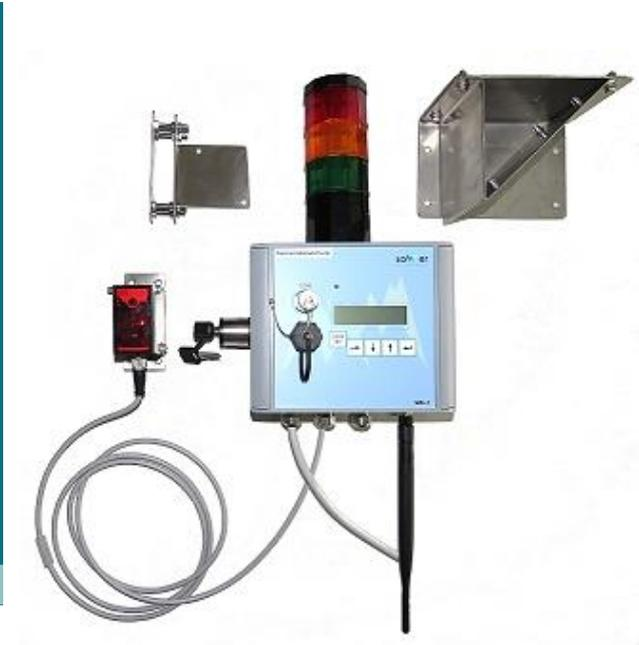
Der LME ist ein laserbasiertes Überwachungssystem zur indirekten Messung von Schneelasten auf Flachdächern. Im Inneren des Gebäudes wird die Verformung der Dachkonstruktion mit einem Laser durch eine hochpräzise Abstandsmessung erfasst und die entsprechende Schneelast ermittelt.
